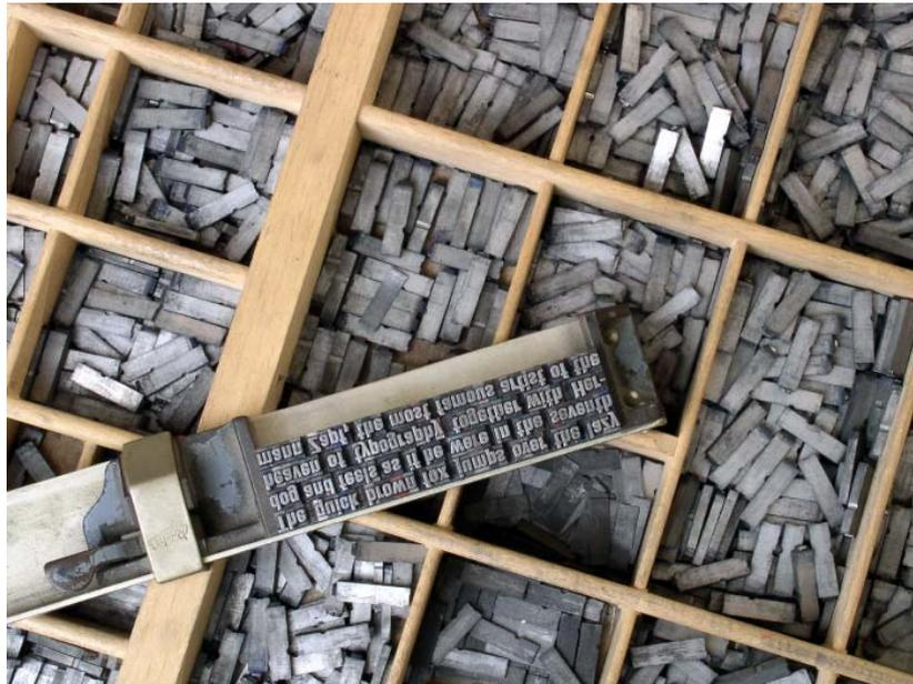
Tipos distribuidos en un cajón de un chibalete. En el componedor se pueden ver varias líneas armadas.
